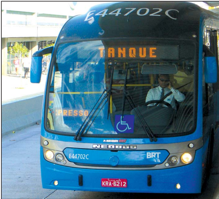
Grandes espaços entre o ônibus e plataforma são problemas constantes
