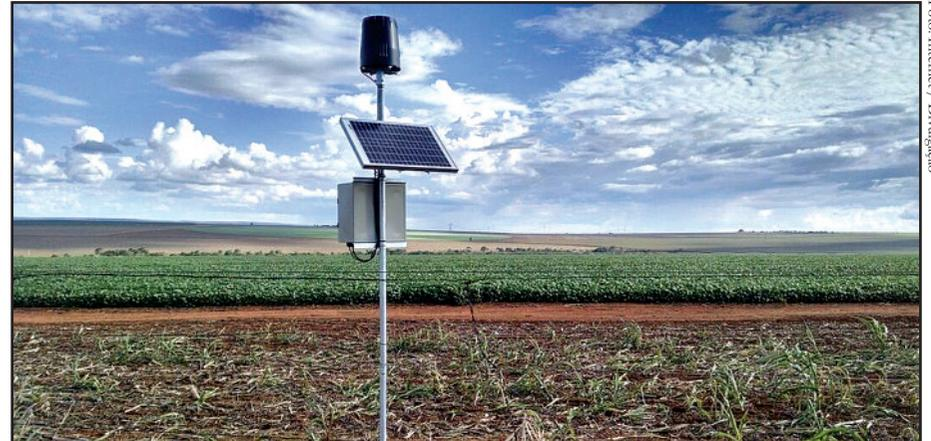
O pluviômetro foi desenvolvido para aplicação de pluviometria remota e automatizada
